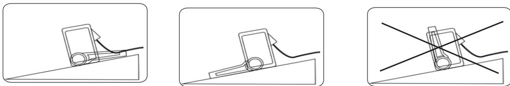
Utilice siempre el soporte incluido para cualquier base tanto horizontal o inclinada, como se muestra en los anteriores diagramas.
