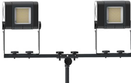
Para el montaje, primero instale adaptador incluido 03.575 en la luz, en el soporte doble(03.5758) , inmediatamente instale las luces y luego instale sobre el trípode, seguidamente, ancle sobre el suelo el trípode y ajustando la las perillas de la luz, acomode a su necesidad y luego icé hasta la altura requerida.
