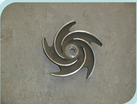
Construcción: Abierto Tipo de flujo: Mixto
