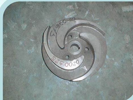
Construcción: Semiabierto Tipo de flujo: Radial
