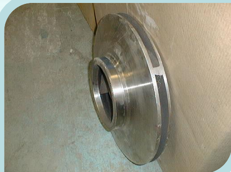
Construcción: Cerrado Tipo de flujo: Radial
