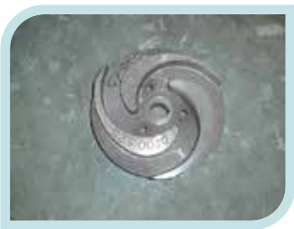
Construcción: Semiabierto Tipo de flujo: Radial
