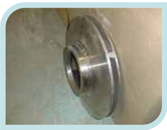
Construcción: Cerrado Tipo de flujo: Radial
