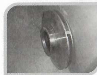
Construcción: Cerrado Tipo de flujo: Radial
