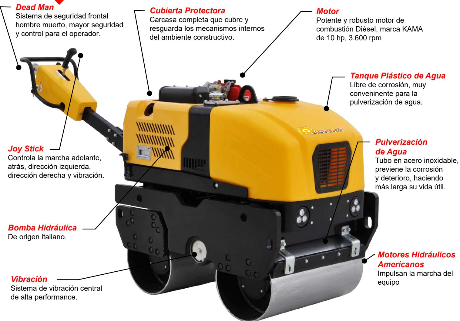
Rodillo vibratorio doble, de accionamiento hidráulico y alto rendimiento, ideal para compactación de asfalto y suelos granulares, su diseño compacto y sistemas de control integrado facilitan su operación en espacios estrechos, confinados o cercanos a muros y andenes.
